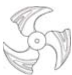
Лопастей, с высоким статическим давлением
